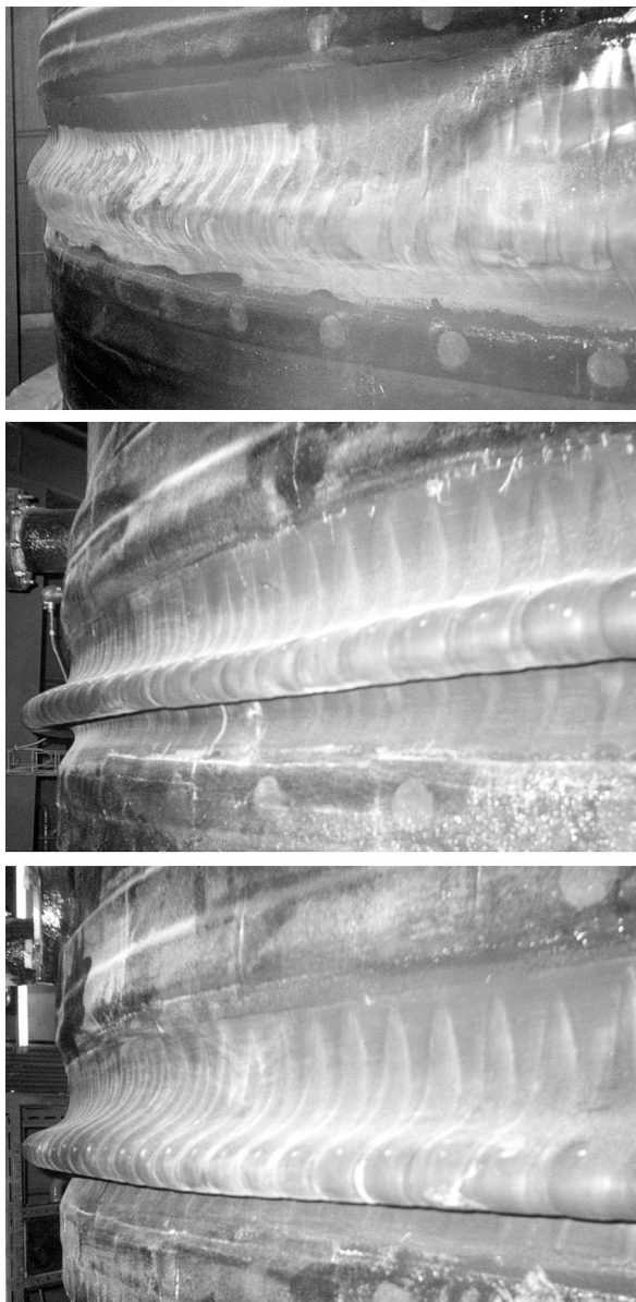
Abb. 14: Kompensatorstelle während der Erwärmung
